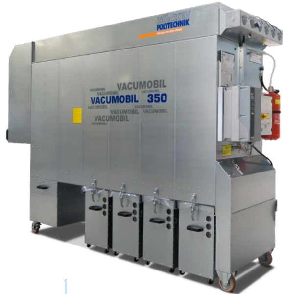
Vacumobil JT 350 met jetreiniging en tonunits
