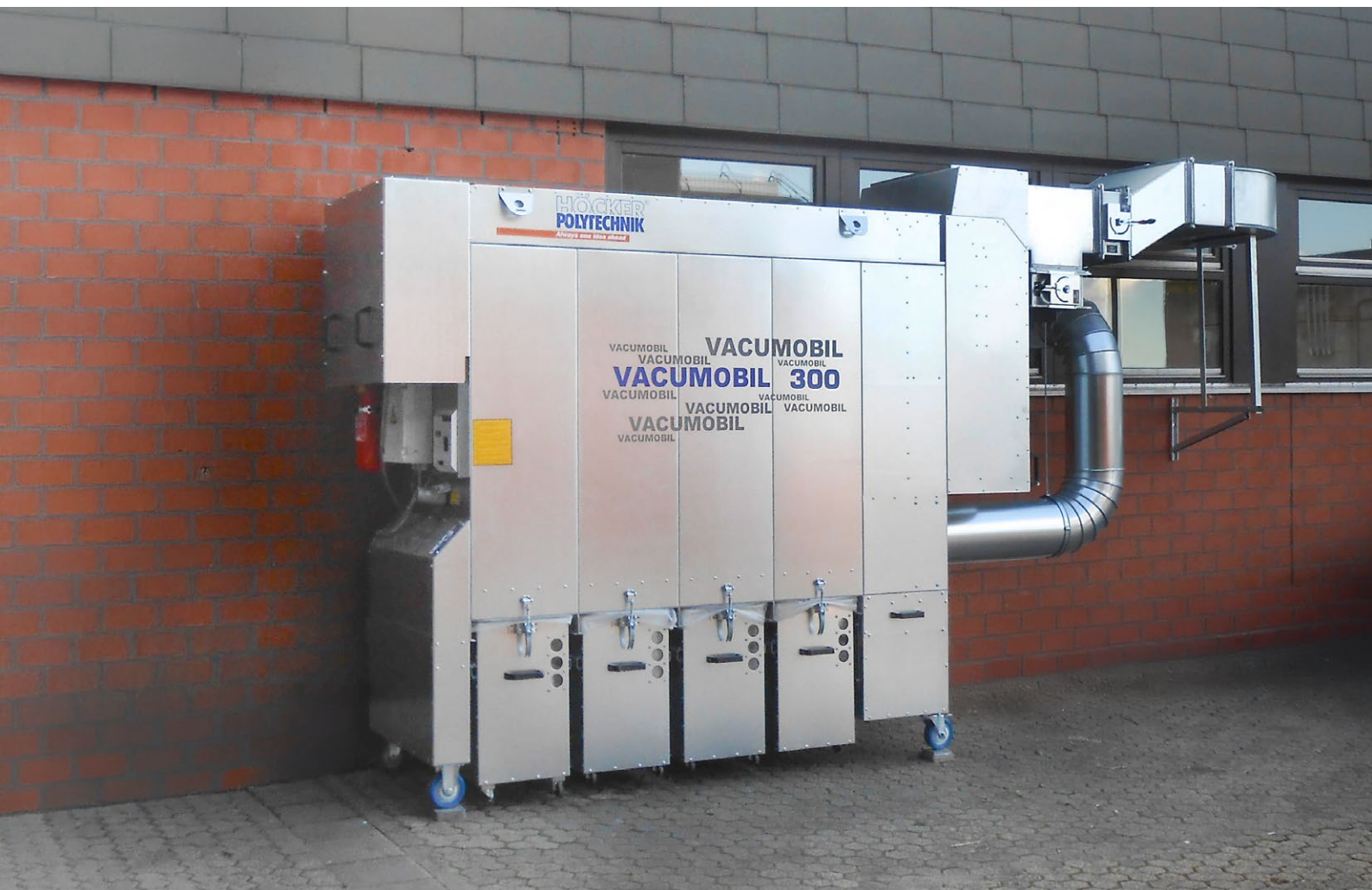
Vacumobil JT 300 in de houtbewerking als buiteninstallatie met retourolucht en afvoer in opvangtonnen.
