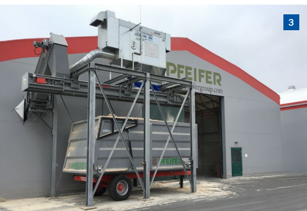
1 Vacumobil 350 met afvoer via draaisluis in grote afvalcontainer
