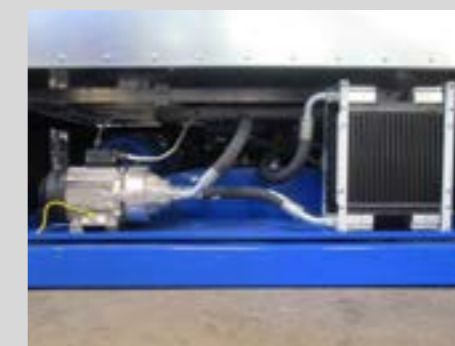
Oliekoeling maakt uw BrikStar C of V perfect uitgerust voor meerploegendienst (met BrikStar C/V 7 en 11 standaarduitrusting)
