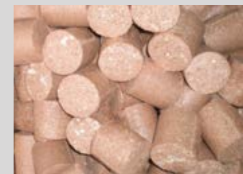
Briketdiameter 55 mm (in plaats van 65 mm) voor moeilijk briketteerbare materialen zoals MDF
