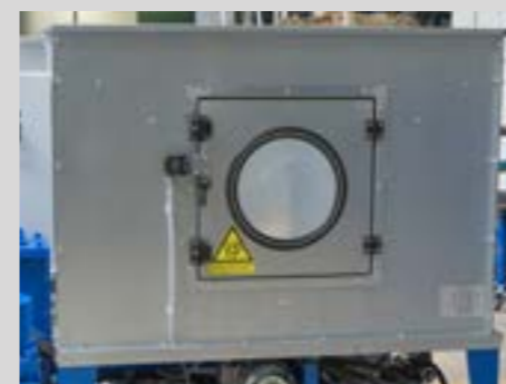
Inspectieluik met kijkvenster
