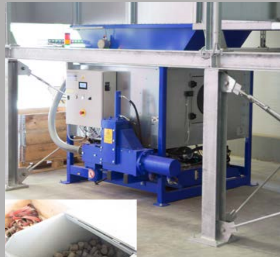
MultiStar filtersysteem met BrikStar C briketpers van één fabrikant van golfkartonnen verpakkingen. Kritische stoffen kunnen veilig in briketvorm worden opgeslagen.
